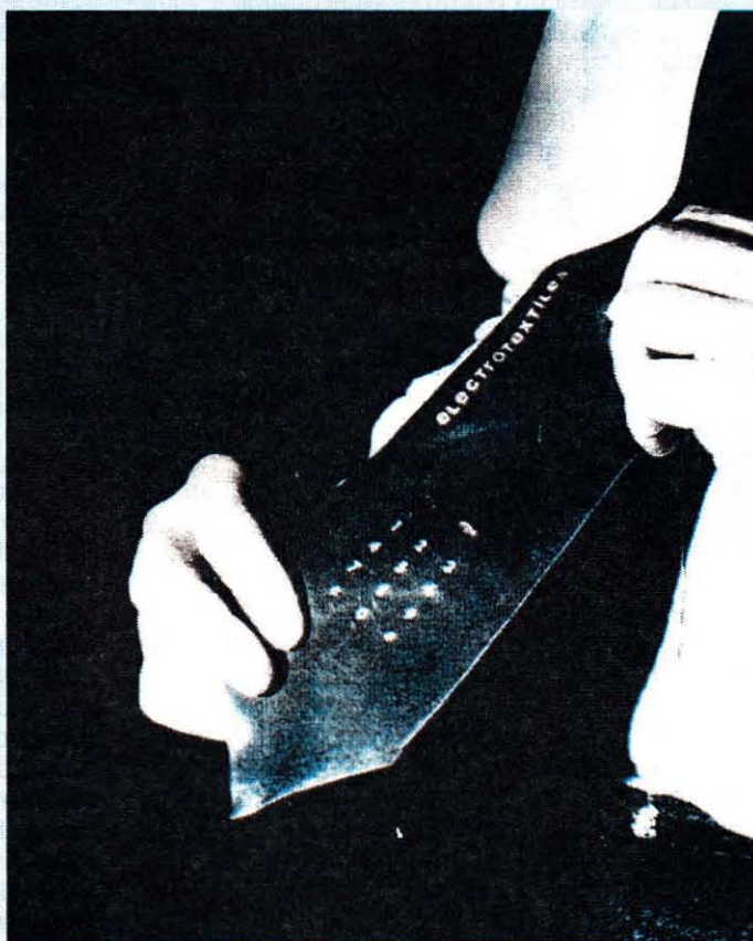
O cravată ce poate servi la efectuarea de calcule matematice, având inserat un ecran plat pliabil, o claviatură și o baterie cu litium tip PEM
